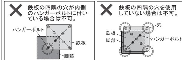
**4** 組み立てが終わったら、ボルトが確実に締められていることを確認し、テーブルを起こします。最後にテーブルにがたつきがないかを確認、脚下のアジャスターで調整してください。
