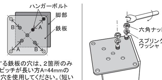
使用する鉄板の穴は、2箇所のみです。ピッチが長い方A=44mmの2つの穴を使用してください。(短い方B=35.5mmは固定できません。)
