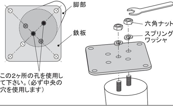
この2ヶ所の孔を使用して下さい。(必ず中央の穴を使用します)
