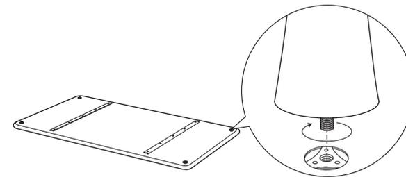
**2** 脚が確実に締められていることを確認し、テーブルを起こします。最後にテーブルにがたつきがないかを確認、脚下のアジャスターで調整してください。
