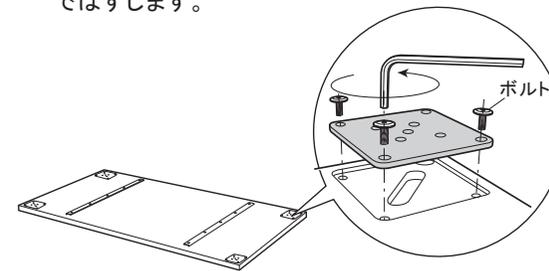
**2** 1ではずした鉄板を下図を参照し脚に取り付けます。脚の外側のハンガーボルトに鉄板の四隅の穴が、内側のハンガーボルトにその対角線上の穴が入るようにセットしてから、スプリングワッシャ、六角ナットの順にねじ込み、平スパナで締め付けてください。
